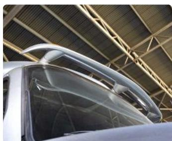
↑ La visera minimiza los reflejos solares en la visión del conductor.
