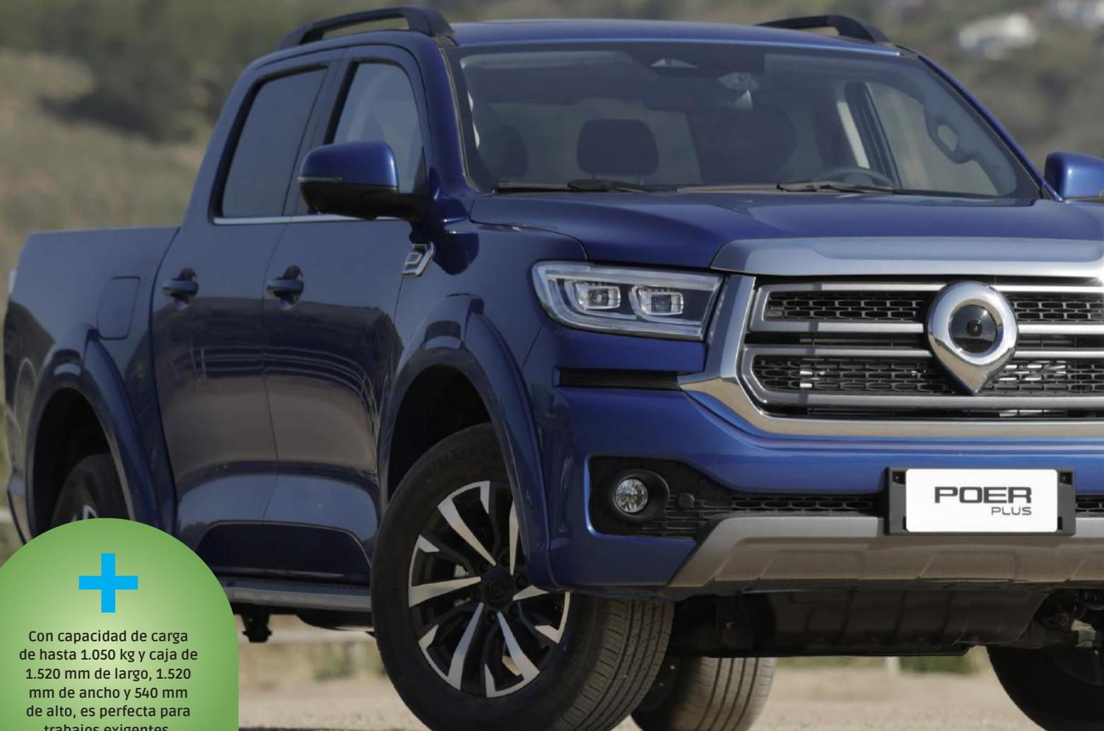
Con capacidad de carga de hasta 1.050 kg y caja de 1.520 mm de largo, 1.520 mm de ancho y 540 mm de alto, es perfecta para trabajos exigentes.
