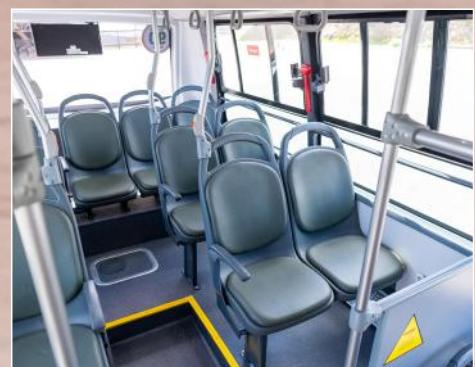
↑ Asientos acolchados con apoyabrazos móviles y diseño ergonómico, con configuración de 23 asientos más una banqueta y el conductor.
