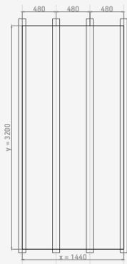
V2. Máx. Carga de diseño del viento: 11,0 kN/m<sup>2</sup>
