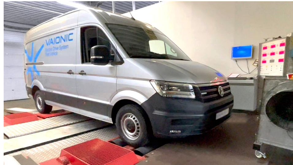
Aufbau Demo Car e-Crafter mit neu entwickeltem Vaionic eDrive System
