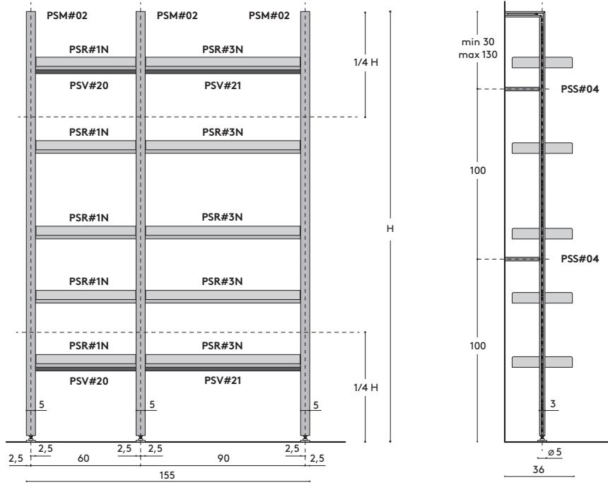
**Wandmontierte Komposition mit Boden-Wand-Deckenbefestigung.**B. Komposition =  $60 + 90 + 5 = 155 \text{ cm}$
