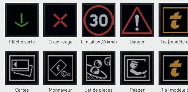
« L'objectif premier de ces équipements est de permettre à l'exploitant la mise en place d'une signalisation dynamique sur les voies de gares de péages conforme à la réglementation. Cette signalisation permet d'améliorer la lisibilité des Signaux d'Affectation de Voies (SAV) et les moyens de paiement proposés à la clientèle des sociétés d'autoroutes.
