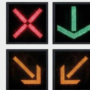
« Les Signaux d'Affectation de Voies (SAV) guident les usagers sur un axe de circulation pour en optimiser la fluidité. Sur les accès à plusieurs voies, ils indiquent celles fermées et permettent de dévier le trafic dans les voies contiguës. Ils sont généralement installés à l'amont et à l'intérieur des tunnels, en sorties d'autoroutes et routes extérieures.
